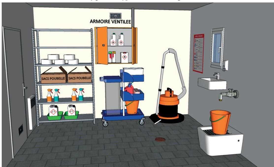
Configuration type d'un local ménage
